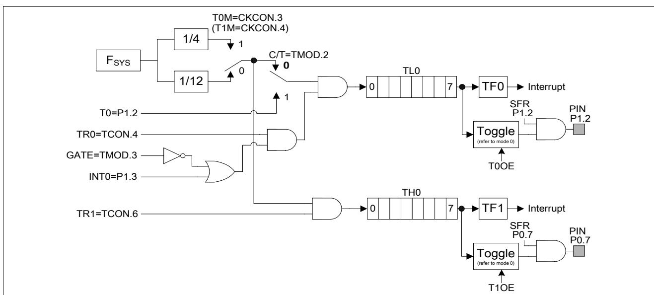
图10-4. 定时器/计数器0 模式3 结构
