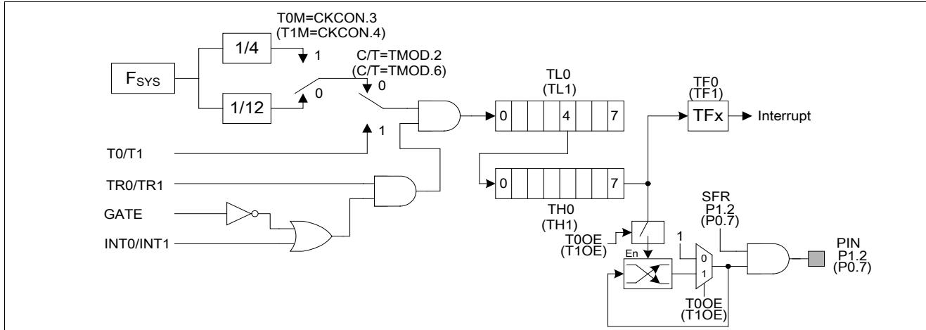
图10-1.定时器/计数器0 模式0 结构
