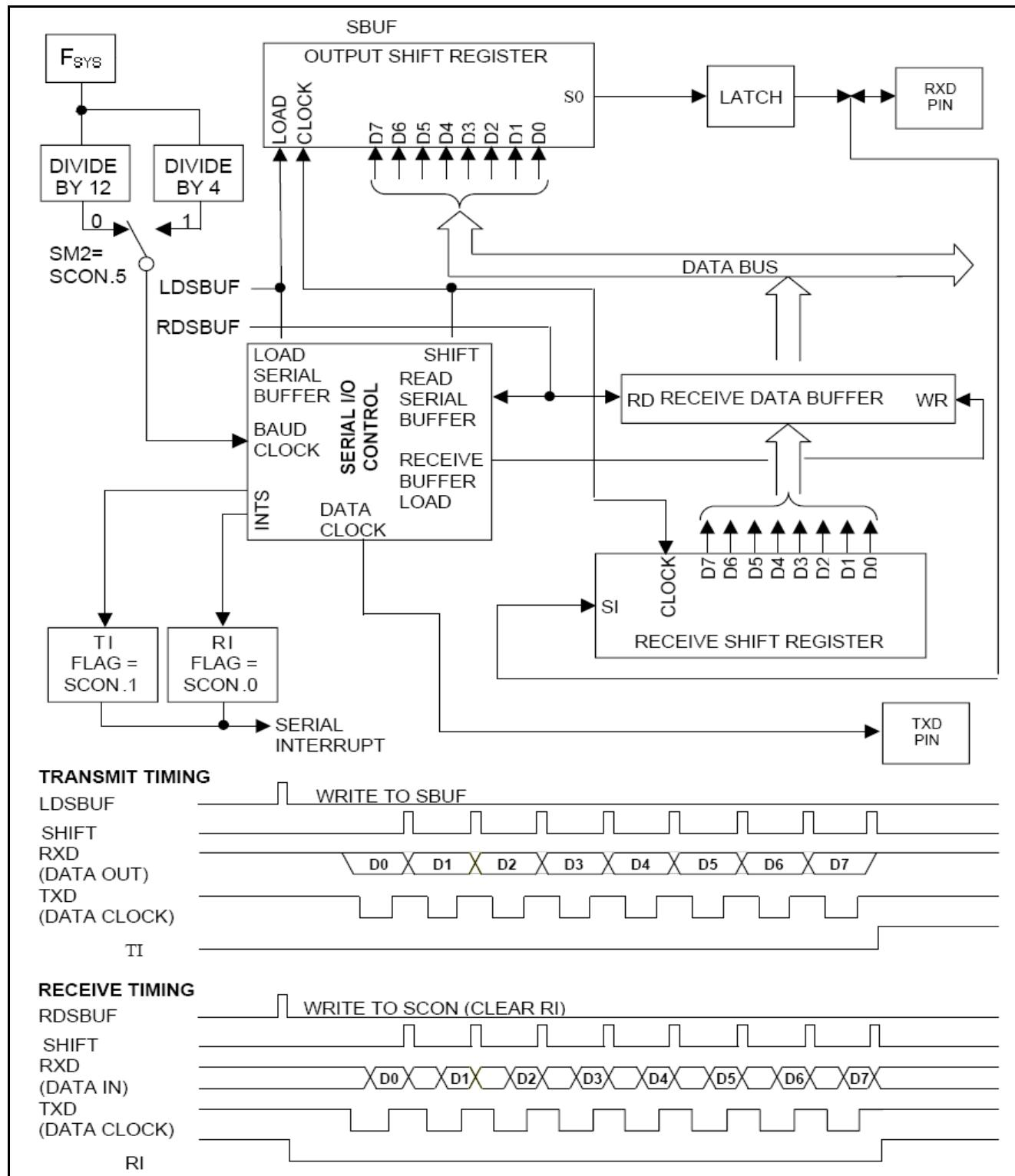
图12-1. 串口模式功能模块及时序图
