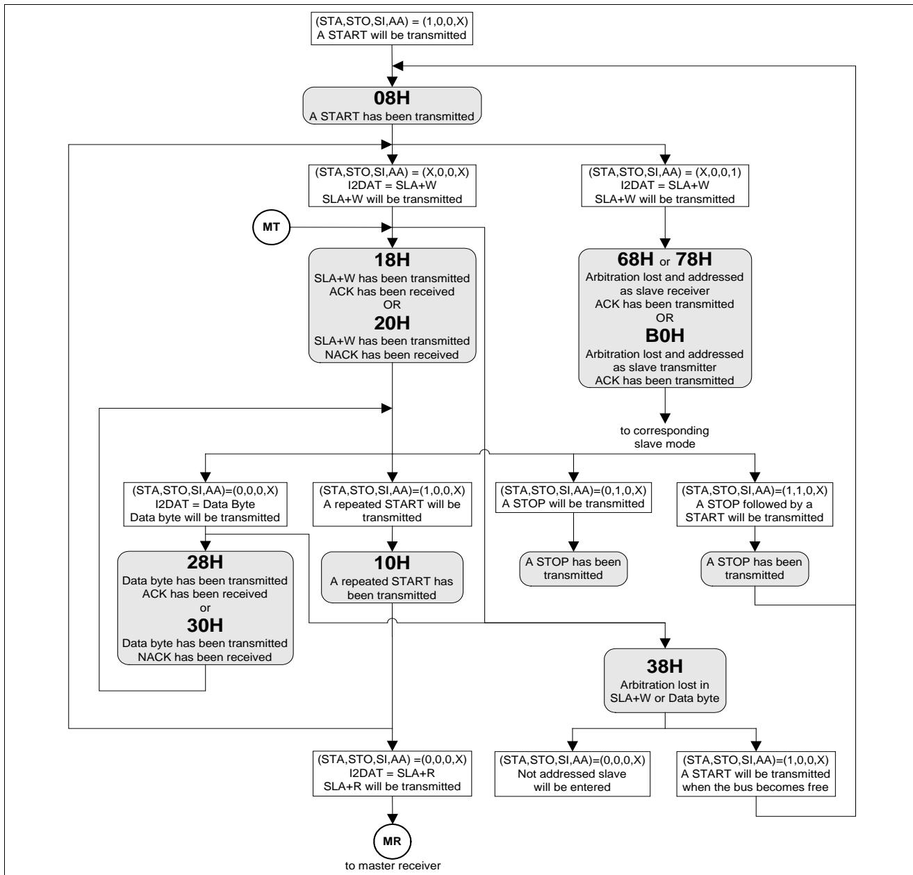
图16-7. 主机发送模式流程与状态
