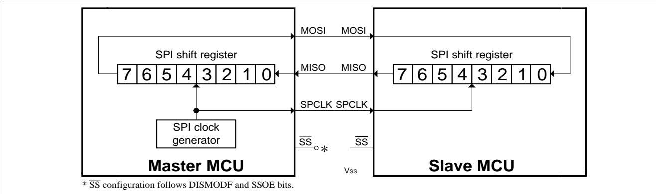
图13-3. SPI 单主机单从机连接示意图
