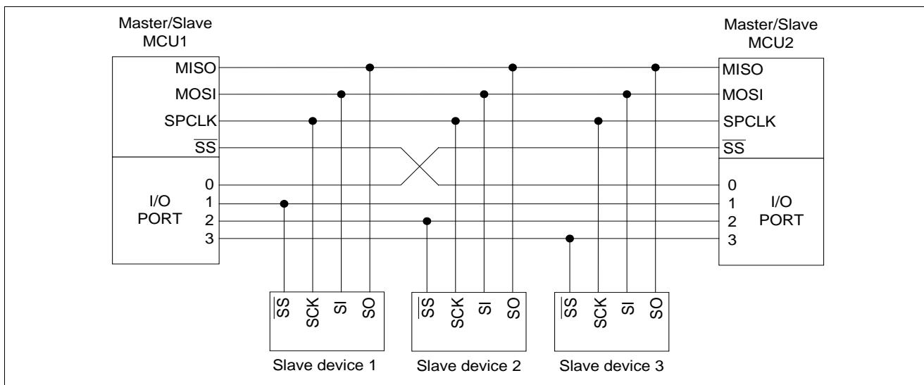
图13-2. SPI 多主机多从机传输机构示意图
