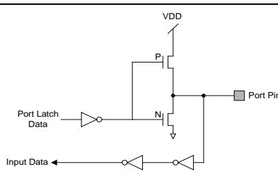
图9-3 推挽输出结构
