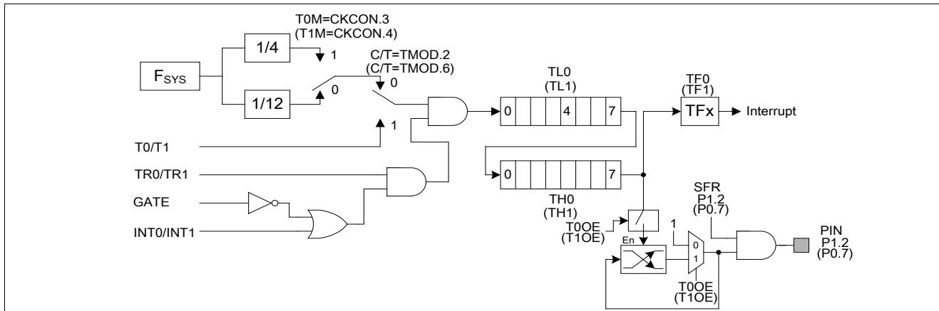
图10-2.定时器/计数器0和1 模式1 结构
