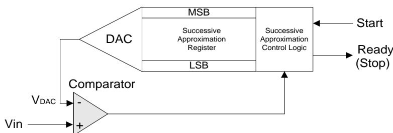
图15-1 逐次逼近型ADC结构
