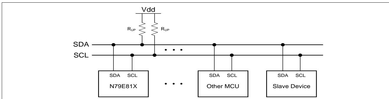
图16-1. I<sup>2</sup>C 总线连接图
