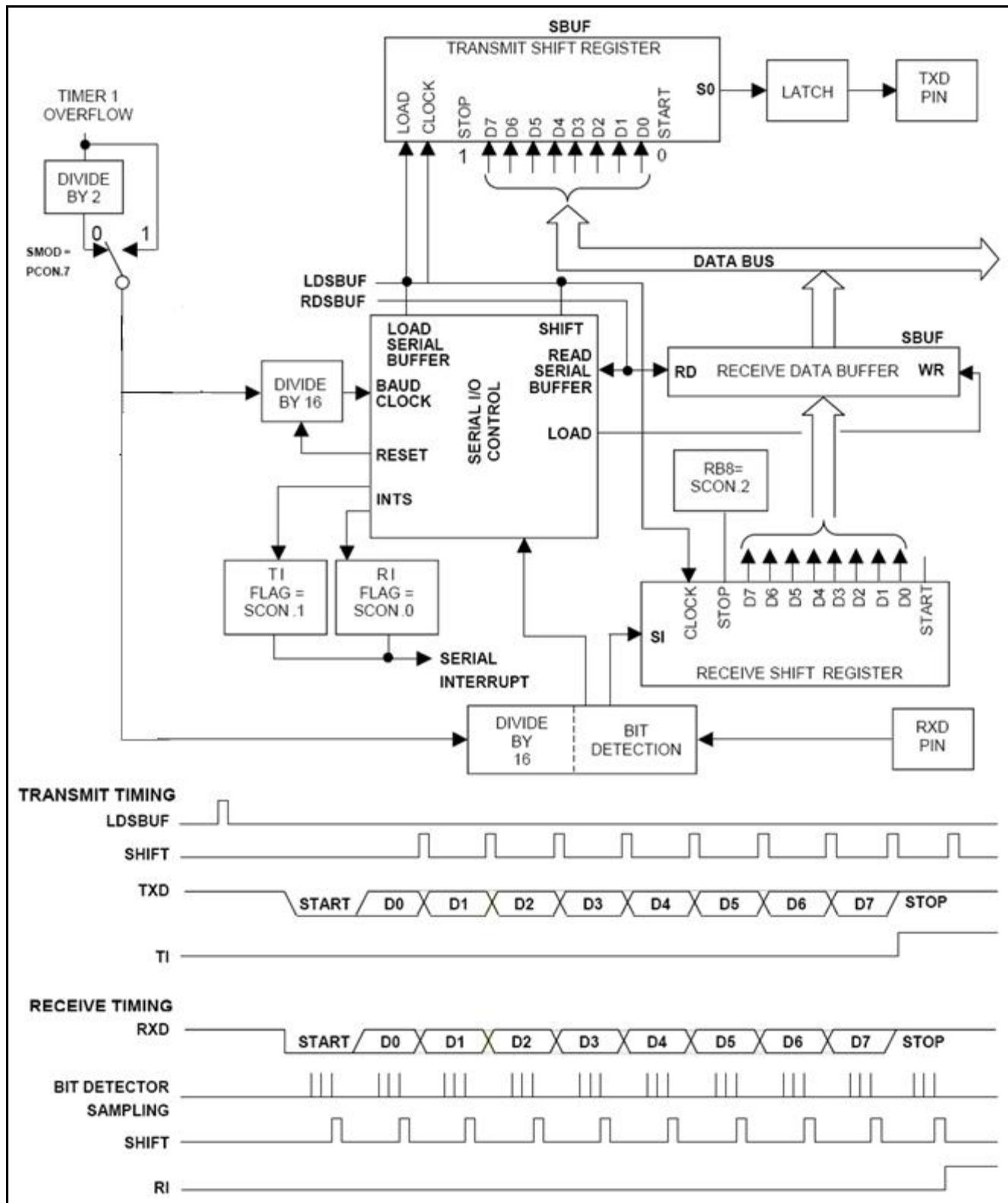
图12-2. 串口模式1功能模块及时序图
