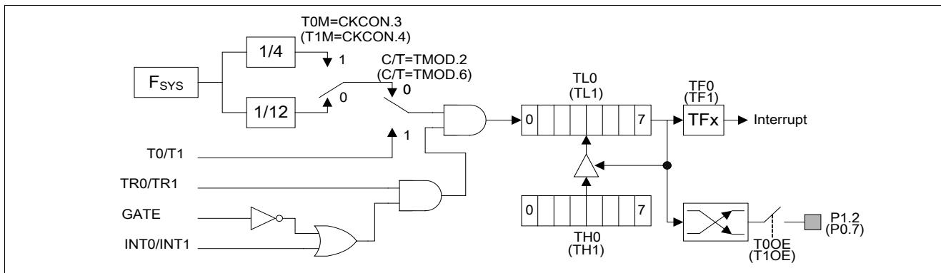
图10-3. 定时器/计数器0和1 模式2 结构
