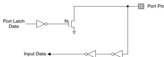
图9-2 开漏输出结构
