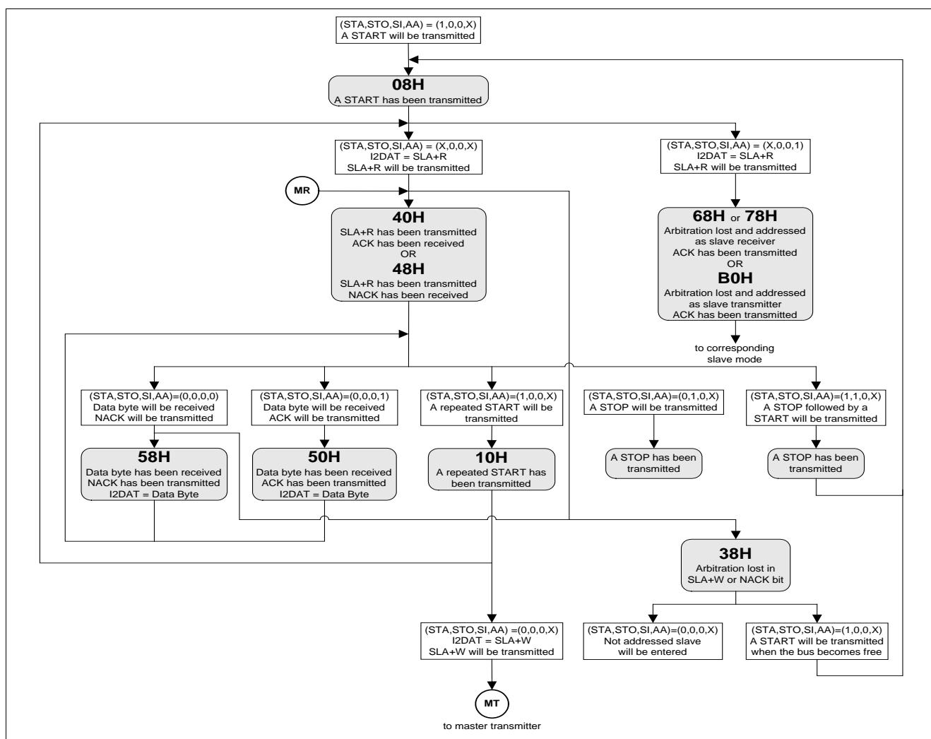
图16-8. 主机接收模式流程与状态
